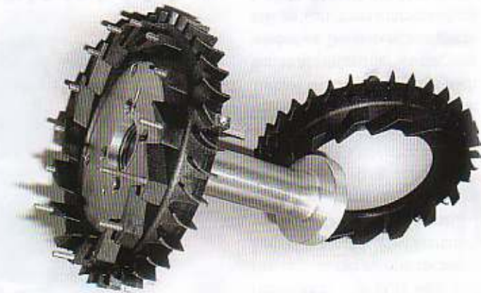
Das Letsystem wird mit einer Alu-Platte am Wellentunnel befestigt
